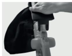
Inserire la maniglia regolabile nel corpo del soffiatore per foglie, regolare il cinturino su se stessi, stringere la vite della manopola (fino a quando la maniglia non si fissa completamente).
