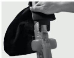
Insérez la poignée réglable dans le corps de la souffleuse à feuilles. Ajustez le bandeau sur vous-même, serrez la vis du bouton (jusqu'à ce que la poignée soit complètement fixée).
